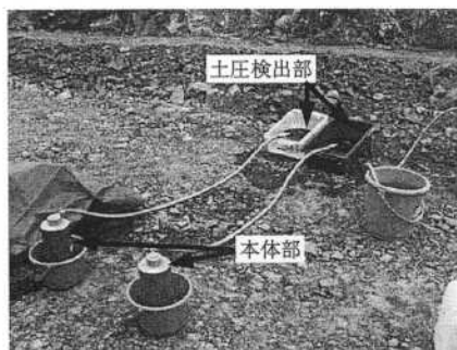
写真-1 間隙水圧・土圧併用型ワイヤレス埋設計器
