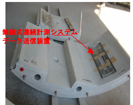
写真-1 セグメントの単体時計測
